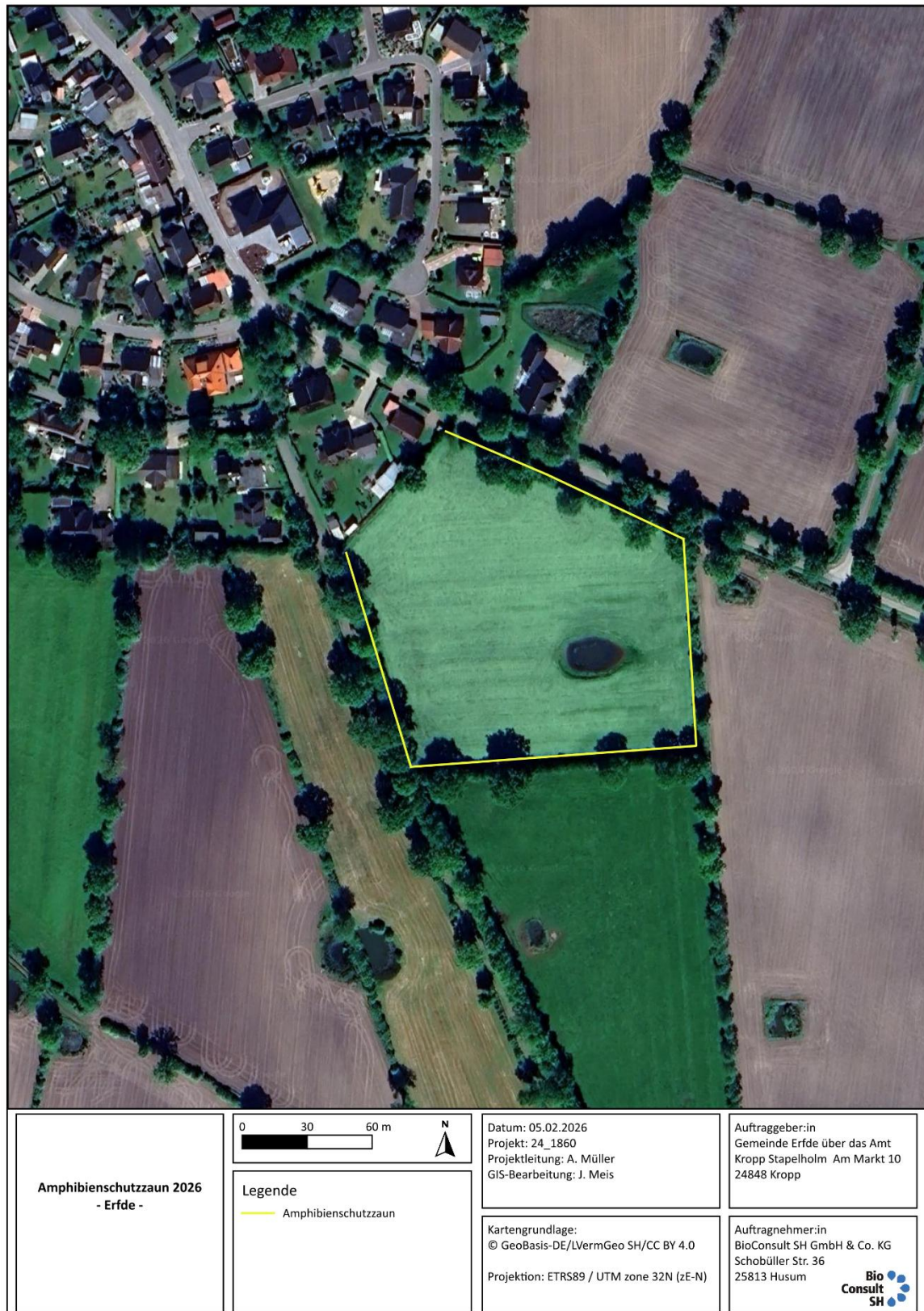
Abb. 5.1 Empfehlung für das Errichten von Amphibienschutzzäunen um den PGB, um das Einwandern von Amphibien aus der Umgebung auf die Baufläche zu verhindern. Eine Anpassung an die Gegebenheiten vor Ort durch die ÖBB ist notwendig.
